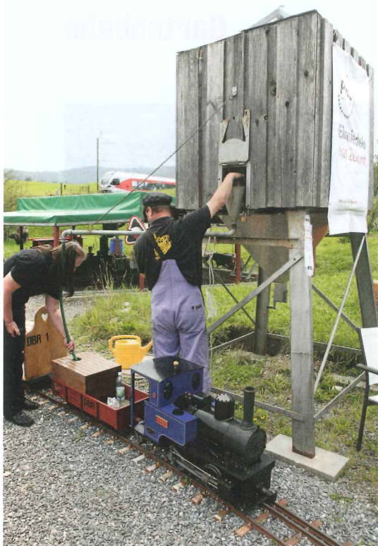
Der Wasserturm fürs aufbereitete Speisewasser.
