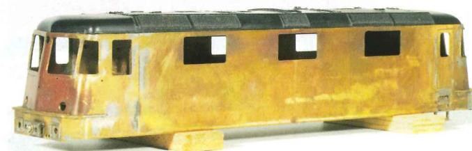
Eine weitere Re 4/4 II im Baustadium aus gefrästen Messingteilen.
