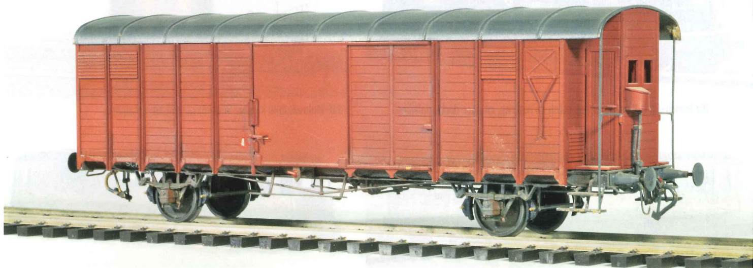
Der gedeckte Güterwagen J3 der SBB aus Messing und Holz entstand aus Teilen eines Modellbaukurses im Modell-Eisenbahn-Klub Wil.
