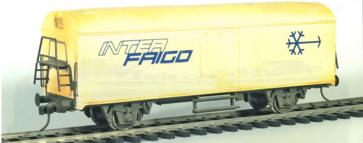
Lima-Kühlwagen aus Kunststoff wurden mit Eiseinfüllöffnungen, Kadee-Kupplungen, neuem Anstrich und neuen Beschriftungen optisch verbessert.
