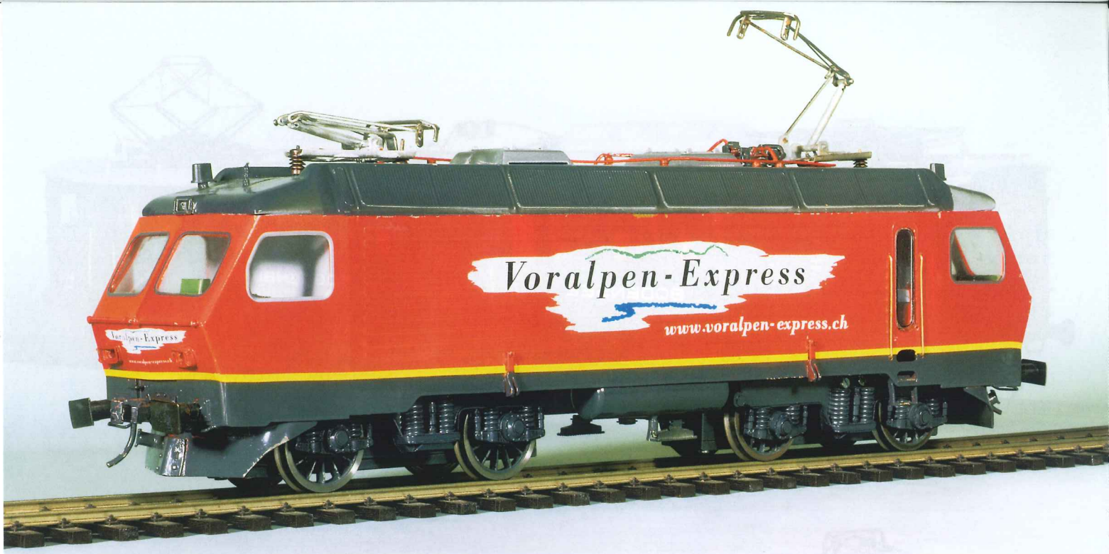
Die Voralpen-Express-Lok Re 446 (ex Re 4/4 IV der SBB) entstand nicht etwa aus einem Bausatz, die Kastenteile wurden gefräst und gebogen.
