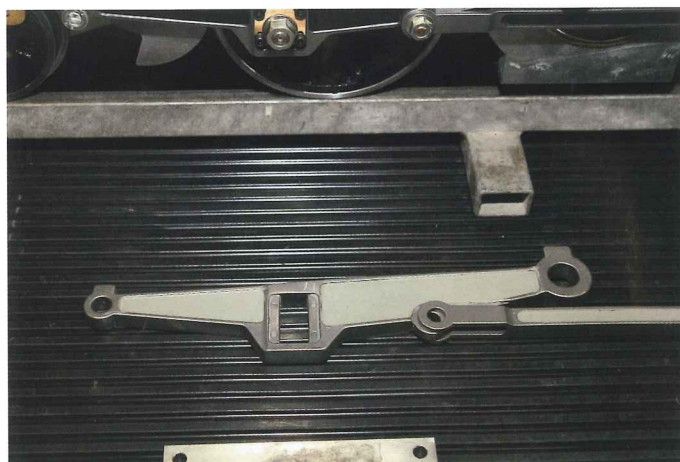
Die Stangenteile wurden auf numerisch gesteuerten Maschinen hergestellt.
