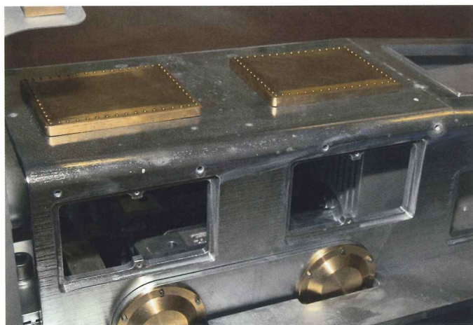
Die massive Bauweise wird am Vorbau ohne die Türen deutlich.
